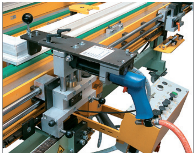
Verfahrbare Bohreinheit für z. B. Dreh-Kipp-Eckband
